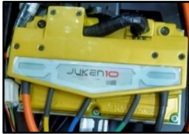
Gambar 3 Controller Motor Listrik Konversi Juken 10
