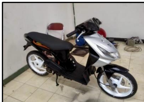
Gambar 11. Sepeda Motor Listrik Konversi
