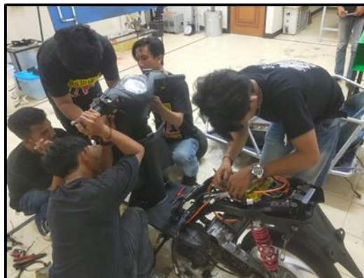
Gambar 9 Proses pemasangan komponen-komponen kendaraan listrik konversi
