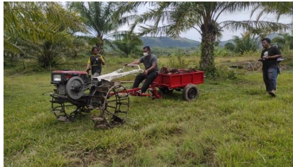
Gambar 1. Pengoperasian traktor menggunakan trailer tipe pivot II [1]
