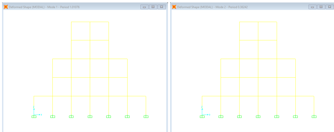
Gambar 2. Periode getar alami mode 1 (kiri) dan mode 2 (kanan)
