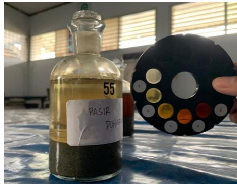
Gambar 1 Pengujian Kotoran Organik Pada Agregat Kasar Sumber: Hasil Penelitian 2022
