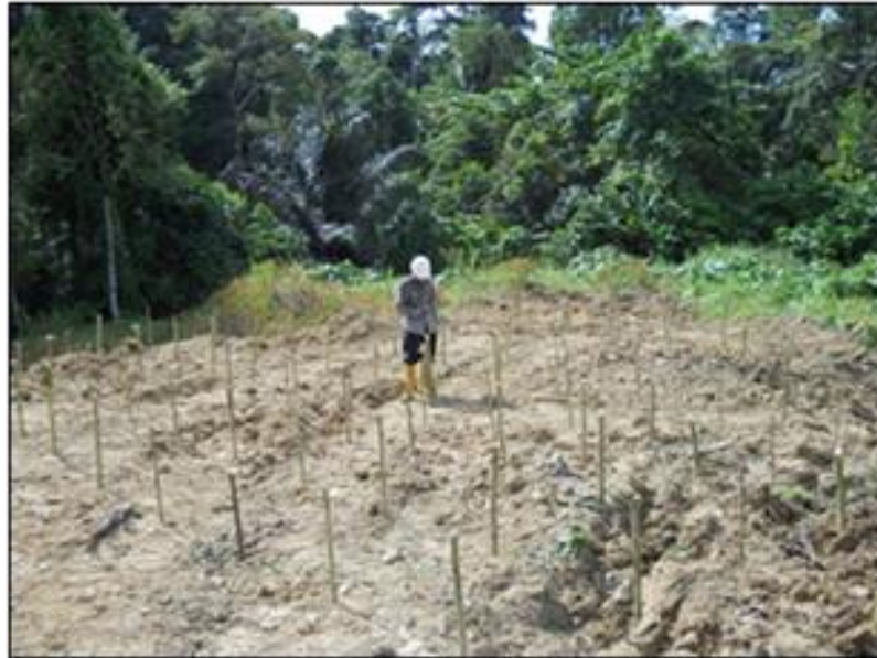
Gambar 2. Pembuatan lintasan uji/simulasi metode geomagnet
