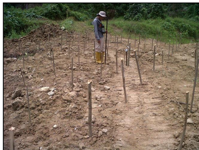
Gambar 8. Pengambilan data geomagnet simulasi dengan jarak sensor ke permukaan 0.5 meter
