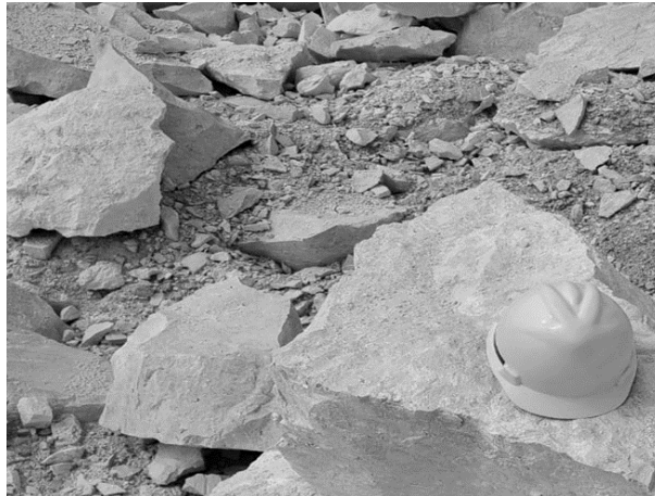
Gambar 4. Fragmentasi Hasil Peledakan Menggunakan Geometri Ideal
