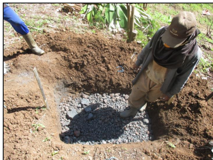
Gambar 6. Tes pit simulasi metode geolistrik
