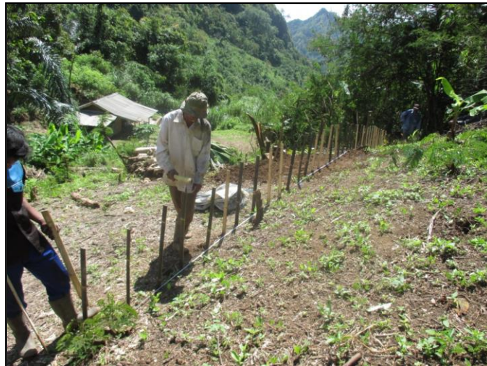
Gambar 5. Pembuatan lintasan uji/simulasi metode geolistrik
