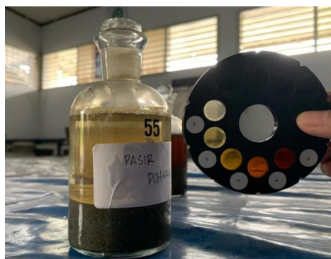
Gambar 1 Pengujian Kotoran Organik Pada Agregat Kasar
